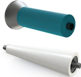
**رولیک مخروطی (کله قندی) :** تفاوت قطر در دو انتهای رولیک باعث ایجاد شکل مخروط میشود و برای انتقال نیرو و حرکت به صورت یکنواخت استفاده می شود و با نصب در طرفین نوار نقاله از انحراف و ماربیچ شدن تسمه نقاله در طول مسیر های طولانی جلوگیری می کند. این رولیک در انواع مختلف مخروطی پرسی ، مخروطی دوتیکه تعویضی و مخروطی تفلونی تولید می گردد.
